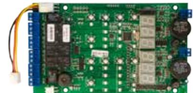
Módulo de 2 zonas para ampliación de las centrales de detección de monóxido VSN-PARK1/2. Cada módulo soporta un máximo de 32 detectores (16 detectores/zona) y dispone por zona de 10 leds de estado, 2 relés de nivel y 1 relé de alarma.
