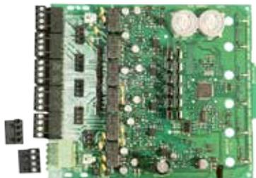
Módulo de control direccionable para sistema analógico MorleyIAS, con 6 circuitos de salida supervisada para la activación de sistemas de señalización o aviso, solenoides, etc. a través del propio lazo analógico. Fácil direccionamiento mediante dos interruptores giratorios decádicos (01-99), ocupando 6 direcciones consecutivas de módulos en lazo. Dispone de leds para la indicación del estado del módulo.
