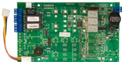
Módulo de 1 zona para ampliación de las centrales de detección de monóxido VSN-PARK1/2. Cada módulo soporta un máximo de 16 detectores y dispone de 10 leds de estado, 2 relés de nivel y 1 relé de alarma.
