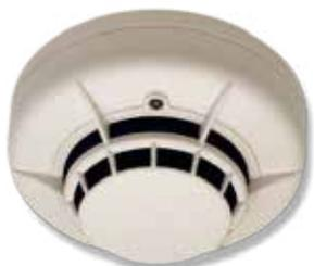
Detector óptico de humos y térmico-termovelocimétrico (58 °C ... 8 °C/minuto) convencional con led de señalización. Supervisión de funcionamiento mediante parpadeo del led. Diseño de cámara que reduce los efectos de la suciedad y accesible sin necesidad de herramientas especiales para mantenimiento. Microsensor incorporado, activable mediante haz de rayo láser codificado para prueba remota. Salida para piloto indicador de acción.
