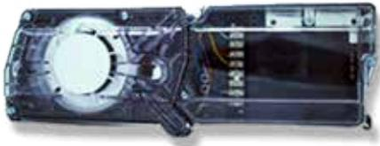
Caja de análisis efecto venturi para la detección de humo en conductos de ventilación y aire acondicionado. Incorpora base B501AP tapa frontal de plástico transparente, salida para indicador remoto y posibilidad de prueba magnética remota.
