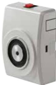
Retenedor de pared de 850N con caja y pulsador, para puerta cortafuego . Caja de plástico reforzado con fibra y pulsador de desbloqueo rojo. El equipo libera la puerta cuando se deja de aplicar la tensión de 24 Vcc. Incluye diodo de protección y polarización y placa ferromagnética articulada Ref. 960114.
