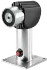
Retenedor de pared de 400N, con soporte abatible a 90° (150 mm) para suelo o 180° (175 mm) para pared. Cabeza giratoria de plástico reforzado con fibra de vidrio y pulsador de desbloqueo rojo. El equipo libera la puerta cuando se deja de aplicar la tensión de 24 Vcc. Incluye diodo de protección y polarización y placa ferromagnética articulada Ref. 960110.
